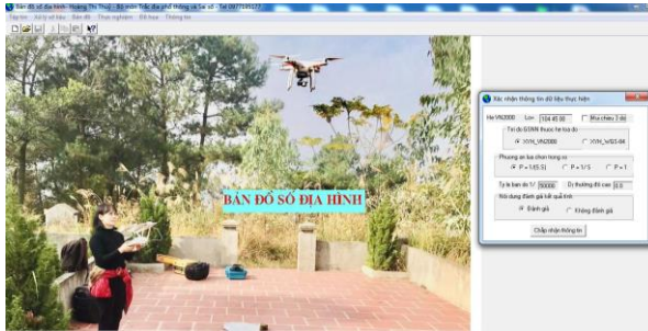
Hình 4. 1 Modul tính chuyển trị đo bằng công nghệ GNSS về hệ tọa độ VN-2000 và độ cao thủy chuẩn
